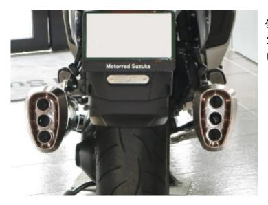
仮付けが終わったら、後ろから見て左右のサイレンサーの高さが水平かつ垂直になるように調整 してください
