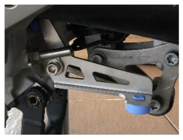
センタースタンドストッパーを外したマフラー ブラケットボルトで取り付けます
