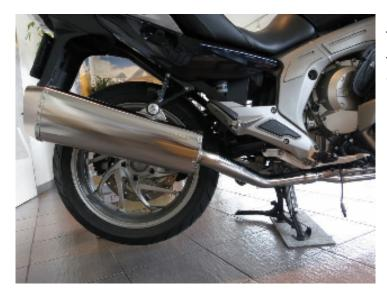
サイレンサーをボルト&ナット(C)とワッシャー(D)で仮付けします(この時スプリングはまだ掛けないでください)
