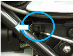
車体左側にある排気ガスフラップの制御ユニットの、 前方にあるカプラーを慎重に取り外します。
